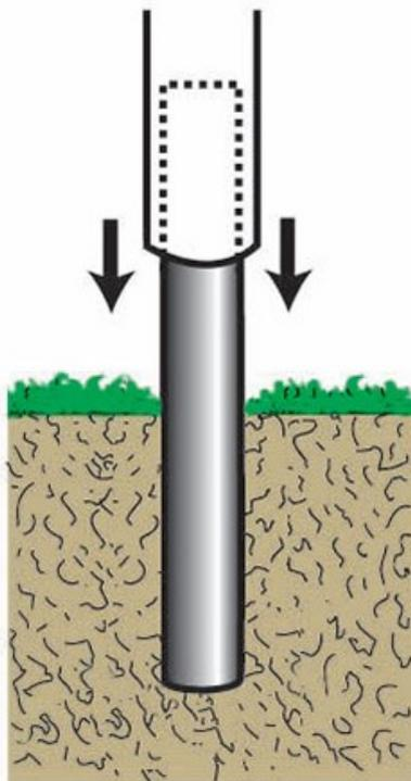
Idéal pour une installation permanente du mât, sans perte de hauteur. Le mât vient recouvrir le tube sortant du sol. Manchon hauteur 150 cm (enterré à 50% dans le sol). Adapté aux mâts diamètre 60 mm à la base.
