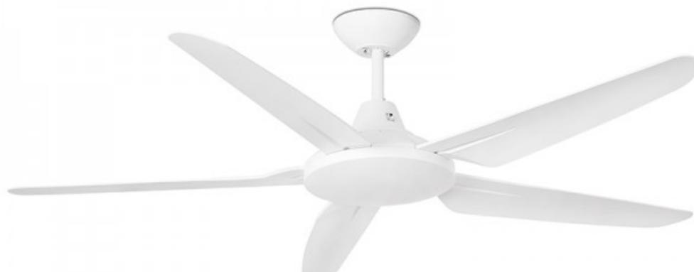
Ventilateur de plafond extra large idéal pour des pièces à partir de 28m<sup>2</sup>. Actionné par un contrôle à distance, inclus, de 3 vitesses réglables 108-162-235 rpm correspondant aux consommations suivantes : 22-43-85W. Il peut être installé sur plafond mansardé et a la fonction été/hiver. Tension 220-240V. Fréquence de fonctionnement : 50/60 Hz. IP : 20. Classe I. Moteur fabriqué en acier et pâles en ABS blanc. Dims (cm) : Ø 188 x H 32. Poids : 6,08 Kg.
