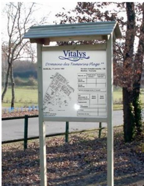
Version sans vitrine et avec toit. Structure bois essence pin nord rouge Finlande, catégorie 5, gage de stabilité et de haute résistance. Traitement autoclave classe IV, sans chrome ni arsenic. Visserie inox A2. Panneau en compact ép. 10 mm ou PVC komacel ép. 10 mm. Livré pré monté, à sceller. Option toit : clin plat à 2 pentes. Option vitrine : plexiglass 6 m, verrou avec serrure. Hauteur 220 cm.
