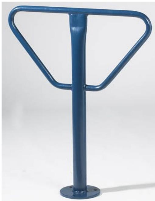
Ces porte vélos sont traités anti-corrosion, en acier galvanisé à chaud (+/- 80 microns), leur apportant une protection remarquable. La coloration est obtenue par thermolaquage (poudre polyester cuite au four), isolant et décoratif. Hauteur hors sol : 90 X Largeur 66 cm. Poteau : tube Ø 60,3 X 2,9 mm. Anneau : tube Ø 26,9 X 2,3 mm. Poids 7 kg. A sceller ou sur platine (à préciser à la commande).
