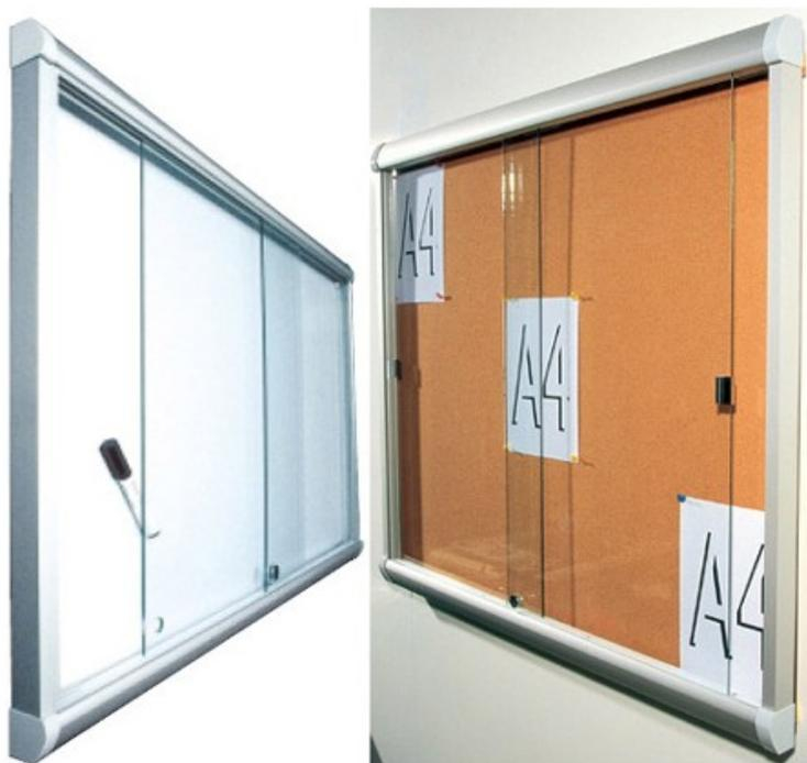
Encadrement aluminium anodisé naturel. Verre sécurit 0,4 cm. Glaces montées sur profil de glissement. Fermeture par serrure à clé. Fond tôle pré laquée blanche pour écriture feutre. Fixation murale inaccessible après fermeture à clé. Capacité 15 A4. Disposition (3 X 5). Dims (cm) hors tout H 98 X L 108,5.
