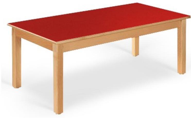
Tailles 0,1,2 ou 3. Table structure 4 pieds 50 x 50 mm en hêtre massif, cadre porteur 80 x 20 mm. Piétement hêtre massif, patins PVC anti tâches, insonores. Vernis naturel ou teinté polyuréthane bicouche. Plateau mélaminé 19 mm chant ABS. 12 coloris au choix. Fabrication UE conforme aux normes NF EN 1729-1 et 1729-2. Normes environnementales : Bois PEFC. Garantie 7 ans contre tous vices de fabrication.
