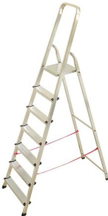
Escabeau ménager de sécurité ALUMIXTE structure en Alu Plateforme en acier zingué Marches antidérapantes en acier zingué Chaussure à 150 kg, testé à 260 kg. Articulations par crosses monoblocs Emboutis antidérapants interchangeables.
