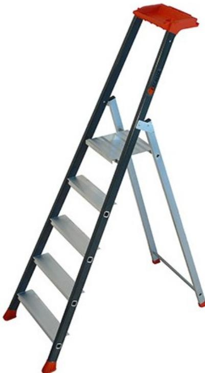
Escabeau aluminium PROLUX PLUS :Marches antidérapantes serties, affleurant les montants, profondeur de 90mm. Plateforme aluminium avec système antibasculement.
