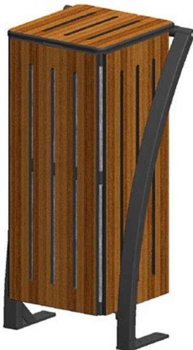
Structure en tube acier 50x30 avec renfort en tôle d'épaisseur 5mm. Bac en tôle d'acier galvanisé avec système de préhension et trous d'écoulement d'eau. Décor en Teck Compact HPL Ep.14mm. Structure finition thermolaquée, plusieurs coloris au choix nous consulter. Dim (cm) : L 46 x P 40.8 x H 93. Poids 44 kg.
