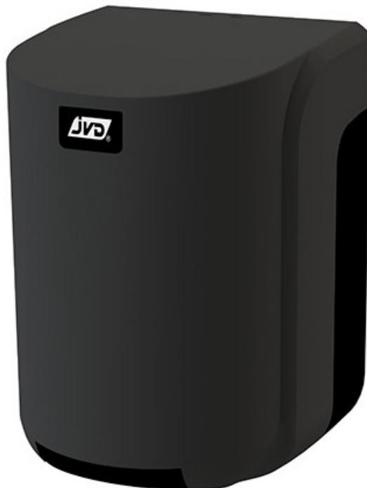
Gamme innovante et design de distributeurs. Capot ABS noir et châssis ABS noir. Fermeture sécurisée avec clé. Visualisation du niveau du consommable. Changement très facile des consommables. 4 points de fixation (kit de montage inclus). Grand dévidoir central d'une capacité de 450 feuilles, bobines diamètre 205 mm. Dims (cm) : L22 x P12 x H31.
