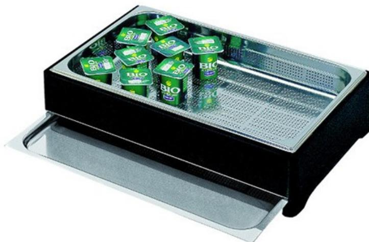
Buffet froid avec base cadre verni pour une protection anti-condensation avec butoir. Bac inox GN 1/1, H 6,5 cm, perforé pour une meilleure circulation du froid. Plateau inox pour glissière GN 1/1. Livré avec 2 plaques eutectique (-12°). Dims (cm) : L 55 X P 35 X H 12. Poids : 8,69 kg.
