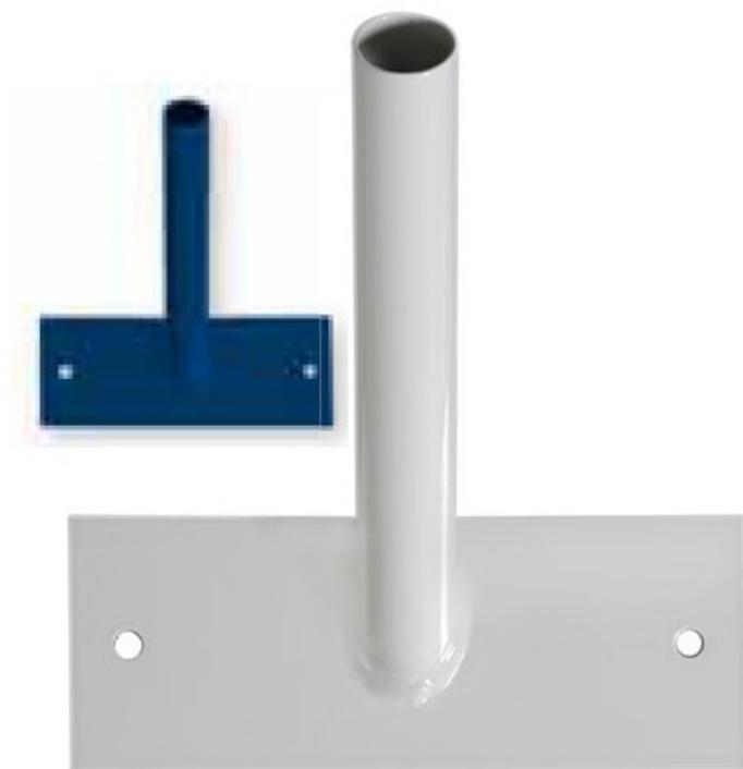
Supports conçus pour la pose de drapeaux à insérer directement dans la buse ou de mâts de façade recouvrant la buse. Réalisés en acier laqué bleu approchant du coloris des hampes de drapeaux (autres coloris, nous consulter). Buse hauteur 21 cm, diamètre 26 mm. Inclinaison 30°. Platine de fixation murale : 20 x 10 cm. Livrée pré-percée (entraxe 17 cm).
