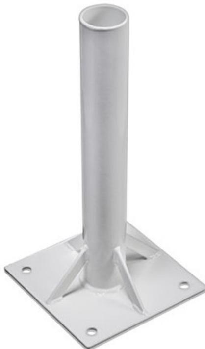
Un support pratique pour éviter les travaux de terrassement et le génie civil. Réalisé en acier laqué blanc. Permet la pose d'un mât de diamètre 60 mm sur une terrasse ou un sol plat. Platine carrée 24,5 x 24,5 cm, percée, à visser directement dans le sol. Fourreau : hauteur 42,6 cm x diamètre extérieur 65 mm. Poids : 7,5 kg.
