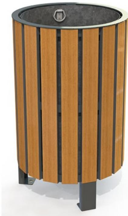
Corbeille moderne avec une belle finition. Structure en tôle d'acier électrozingué ép. 3 mm, Finition thermolaquée, coloris au choix selon RAL. Habillage en lames de stratifié compact ép. 14 mm. Finition aspect teck. Bac intérieur en tôle d'acier galvanisé. Fixation au sol sur sol béton par chevillage. Volume 60 L. Dims (cm) : diamètre 43,5 x H71,9. Poids : 23,5 kg.
