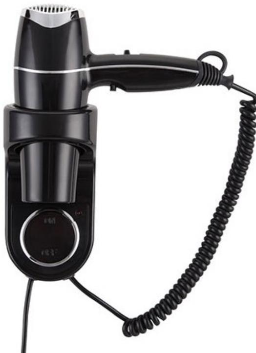
Sèche-cheveux mural automatique type pistolet. Capot en ABS, coloris noir et chrome. Puissance totale 200 à 2000 W. Puissance moteur : 48 W. Niveau sonore : 62 dB. Vitesse de l'air : 26 m/s. Température de l'air : 65°C. Tension : 220-240 V, fréquence 50/60 Hz. Classe II.
