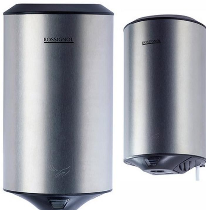
Sèche-mains compact et robuste, s'adapte à tous les espaces sanitaires. Temps de séchage : 10 à 15 secondes. Capot en inox brossé AISI 304. Puissance 1150 W. Déclenchement automatique. Vitesse de sortie de l'air 245 km/h. Tension alimentation 220/240V. Fréquence 50/60Hz. Protection électrique Classe I, IPX1. Niveau sonore : 72 dB. Dims (cm) : L15,3 x P16 x H28.
