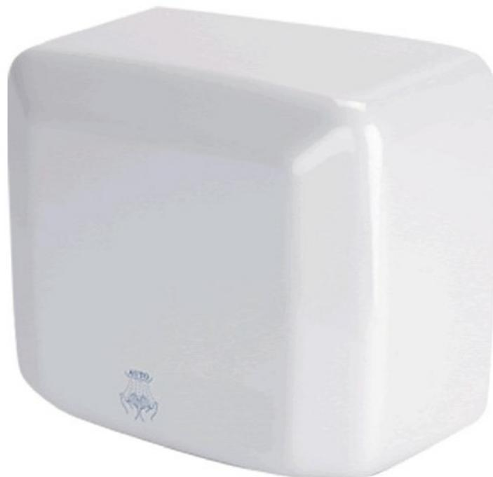
Sèche-main robuste particulièrement efficace et économique. Capot en acier, antivandalisme, épaisseur 2 mm. Finition peinture époxy coloris blanc. Déclenchement automatique par cellule. Arrêt automatique en cas de surtension. Temps de séchage 15 secondes. Puissance 2500 W. Niveau sonore : 70 dB. Livré avec son kit de fixation murale. Dims (cm) : L27 X P14,2 X H24. Poids : 5,40 kg. Garantie 3 ans.
