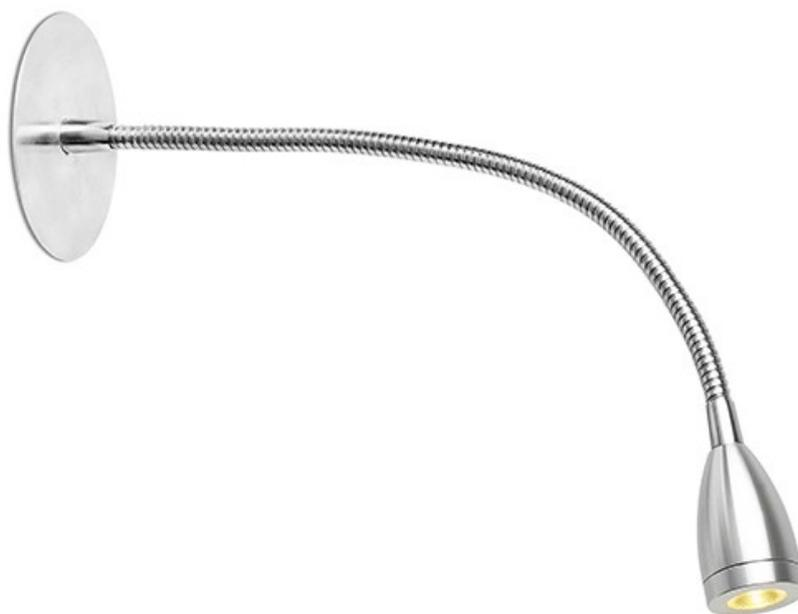
Lampe de bureau encastrable LED. Composé d'aluminium et de verre. Elle est idéale pour éclairer les espaces de lecture et des zones d'étude grâce à son bras articulé. Ampoule LED 3W 3000K 150Lm 35° CRI>80 incluse. Transformateur : driver inclus. Tension : 100-240V. Fréquence de fonctionnement : 50/60Hz. Classe II. Poids : 0,40 kg. Dims (cm) : L 8 x P 32 x H 8 x Ø3.
