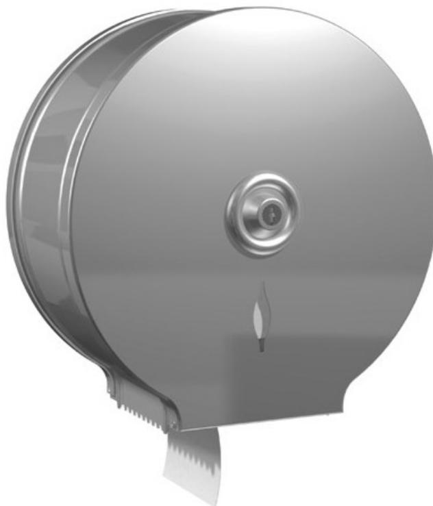
Capacité : bobine de 400 m. Capot et châssis antivandalisme en acier, finition inox satiné. Facile à recharger, à nettoyer et à entretenir. Fermeture sécurisée avec clé. Fenêtre de visualisation du niveau des consommables en façade. Mandrin diamètre 45 mm. Découpe facile droite et gauche. Fixation murale 4 points (kit de fixation inclus). Dims (cm) : L 29 X P 12 X H 32,6.
