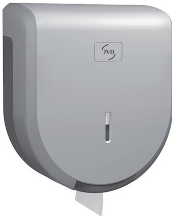
Capacités : rouleaux de 400 m. Mandrin diamètre 45 mm. Découpe facile. Capot et châssis ABS gris métal. Fermeture sécurisée avec clé. Visualisation du niveau du consommable. Changement très facile des consommables. 4 points de fixation (kit de montage inclus). Dims (cm) : L 28,5 X H 32 X 12.
