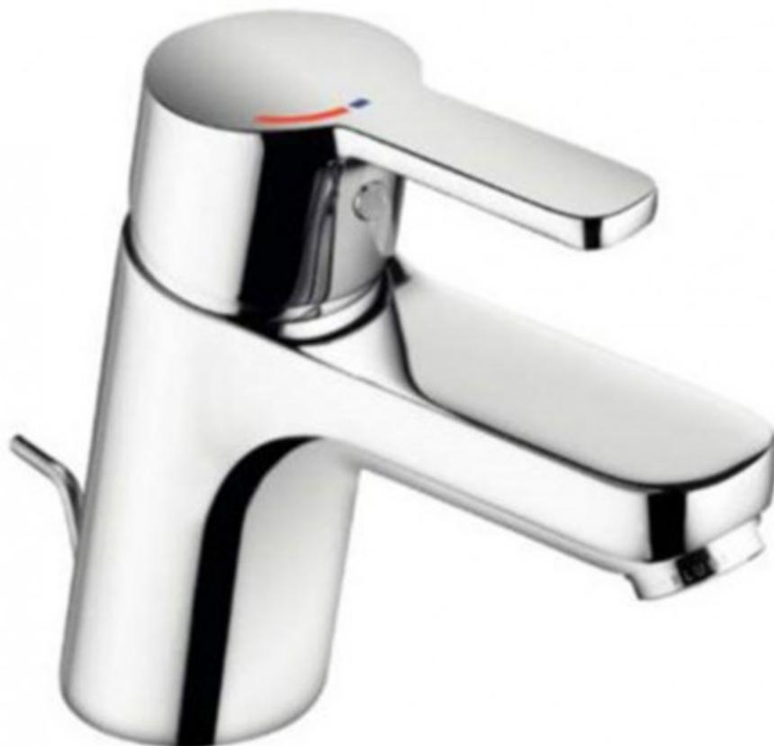
Mitigeur de lavabo levier plein avec finition chromé. Montage monotrou. Débit classe Z. Mousseur éco M 24 x 1. Cartouche céramique avec limiteur eau chaude. Position centrale eau froide. Garniture de vidage G 1 1/4. Système de montage rapide. Raccords flexibles G 3/8.
