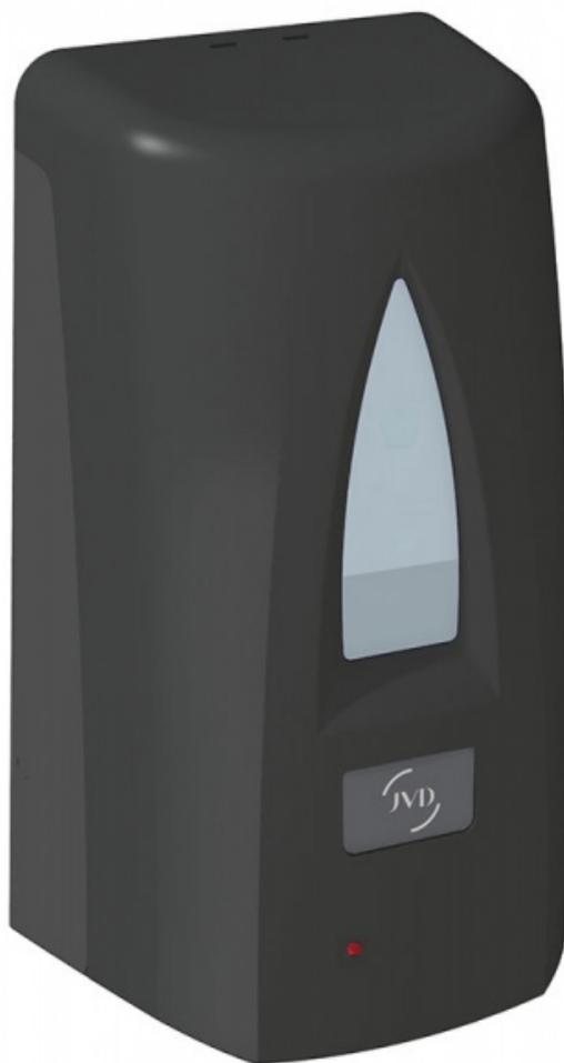
Distributeurs automatiques de savon gel pour une meilleure gestion des consommables. Détecte automatiquement les mains. S'éteint automatiquement à l'ouverture du capot. Réservoir amovible pour un remplissage et un nettoyage aisés. Débit : 1 ml par dose (gel). Fabriqué en ABS. Coloris noir mat. Visualisation du niveau. Fermeture à clé. Répond à la démarche HACCP. Alimentation : 4 piles 1,5 V type LR14 (non fournies). Dims (cm) : L 15,8 X P 10,6 X H 29,6. Garantie 2 ans.
