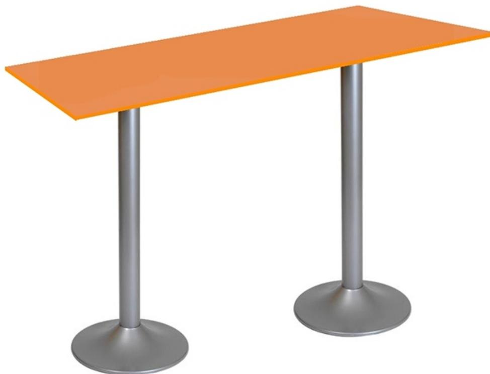
Des tables snack idéales pour aménager vos espaces de restauration. Piétement comprenant 2 colonnes centrales en tube d'acier Ø 80 mm avec des socles lisses en fonte de Ø 45 cm. Socles munis de patins de protection des sols. Finition peinture époxy et polyester. Plateau résistant stratifié ép. 25 mm avec chant ABS. Nombreux coloris au choix de piétements et plateaux, nous consulter. Hauteur : 108,7 cm. Fabrication Française. Garantie 3 ans.
