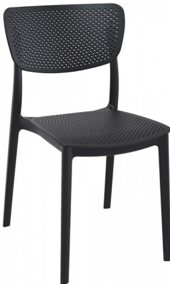
Une gamme de chaises empilables modernes et robustes. Grâce à leur structure en polypropylène renforcée avec de la fibre de verre injectée, ces chaises et fauteuils résistent aux intempéries et manipulations. Usage intérieur ou extérieur. Coloris noir. Dims (cm) chaise : L 45 X P 53 X H 82, assise H 45. Poids : 3,3 kg.
