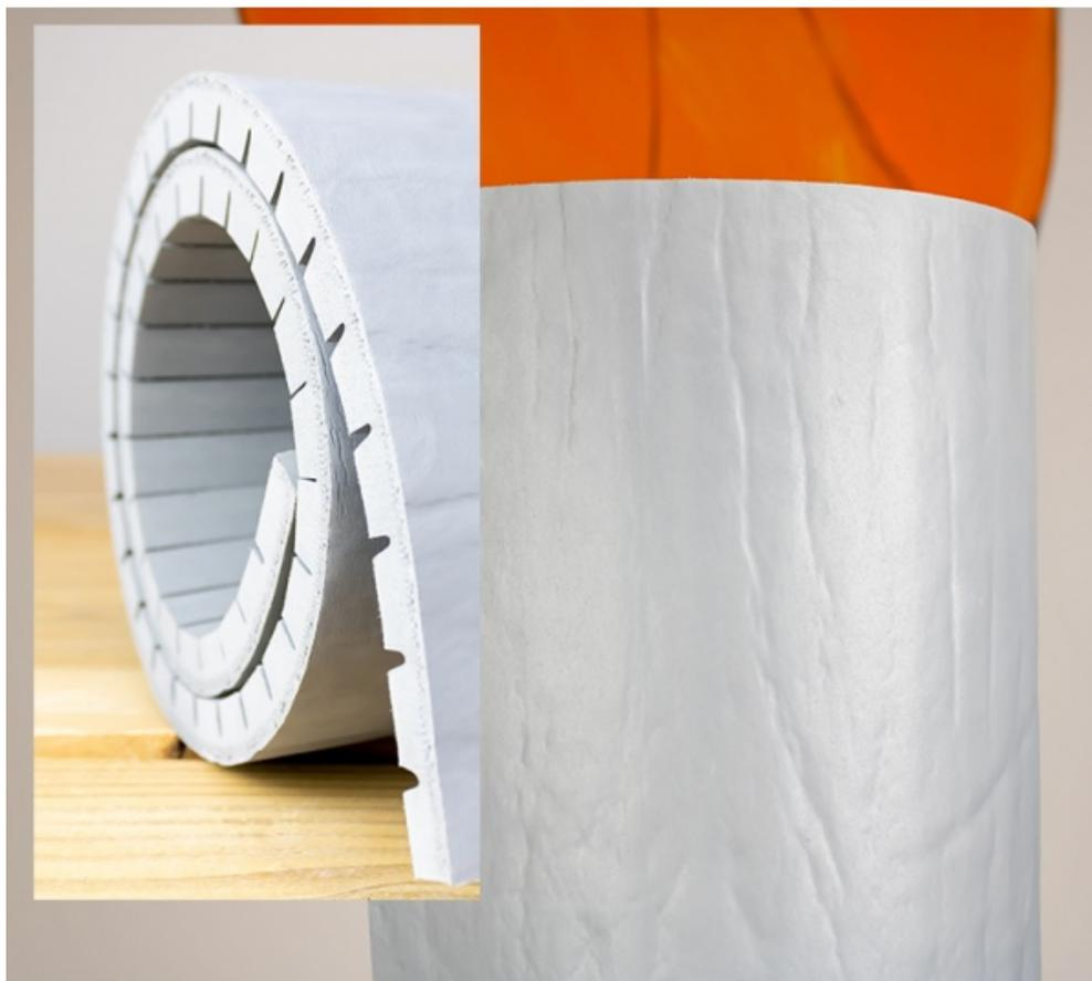
Protection pour poteaux et murs absorbant les chocs. Convient à l'extérieur comme à l'intérieur, résistant aux intempéries. Résistant aux morsures. Facile à nettoyer. Matériaux antitoxiques. A installer avec une colle MS Polymer ou Néoprène (en option). Certification EN 71 et UNI 913:2009. Modèle lisse L107,5 x P1,8 x H99,5. Deux coloris au choix : blanc RAL 9016.
