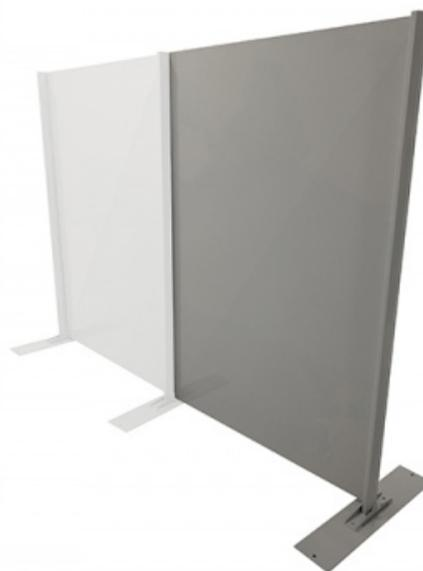
Une solution de cloisons autostables robustes et modulaires permettant de s'adapter à toutes les configurations. Système de modules départ, suivant et d'angle. Matériaux 100% recyclables. Modèle version tôlée ép. 0,8 mm. Les pieds des cloisons sont équipés de platine de 70 x 15 cm permettant d'assurer une parfaite stabilité. Longueur : 120 cm. Fabrication Française. Élément suivant = 1 poteau + 1 pied + 1 panneau + fixations.
