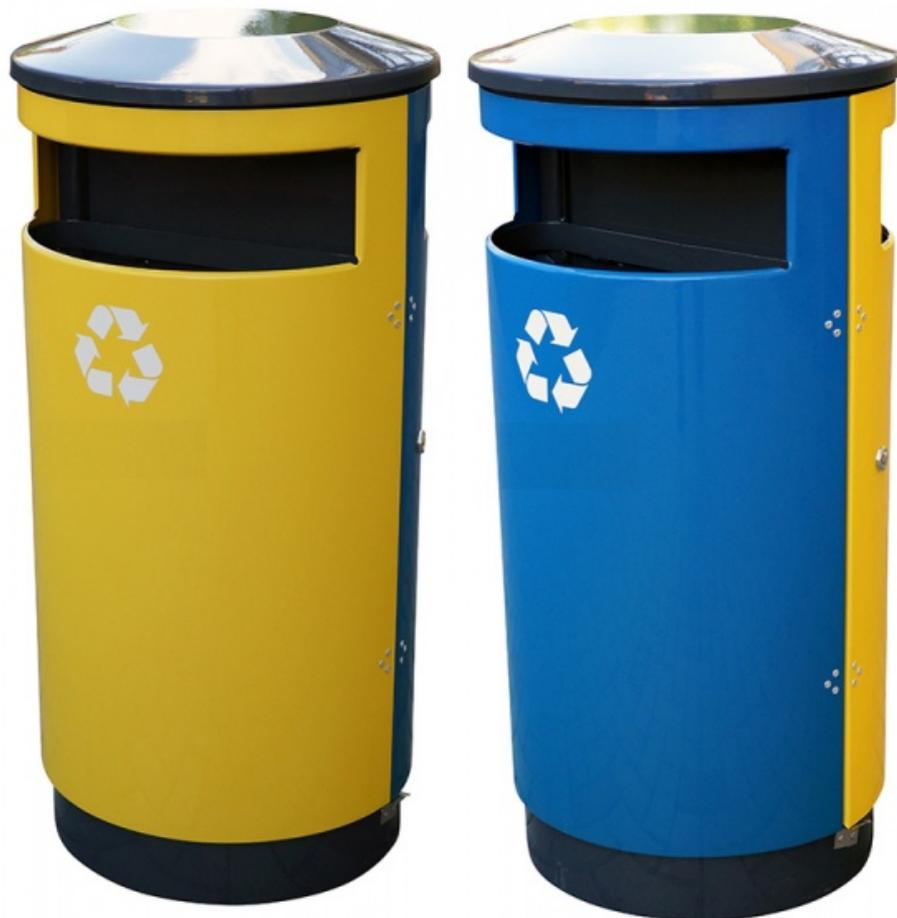
Moderne, simple et pratique, cette corbeille permet d'effectuer facilement un tri sélectif. En acier galvanisé, elle est à poser ou à sceller. Finition avec peinture polyester labellisée haute résistance et traitement anti-corrosif et anti-UV. Support sac. Serrure automatique. Plusieurs coloris au choix, nous consulter. Dims (cm) : Ø 42 X H 87. Volume : 2 X 40 Litres. Poids : 21 kg.
