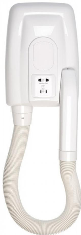
Sèche-cheveux mural avec flexible et prise rasoir, pratique et économique. Capot fabriqué en ABS, coloris blanc. Activation par capteur infrarouge électronique. Arrêt automatique en raccrochant la poignée. Puissance totale 900 W. Moteur 70 W avec 3 vitesses. Type D.C.. Vitesse d'air : 51 km/h. Prise rasoir européenne et américaine. Classe II. IPX1. Tension : 220-240 V / 50-60 Hz. Montage mural. Dims (cm) : L18,3 x P10,4 x H25,3. Poids : 2,2 kg.
