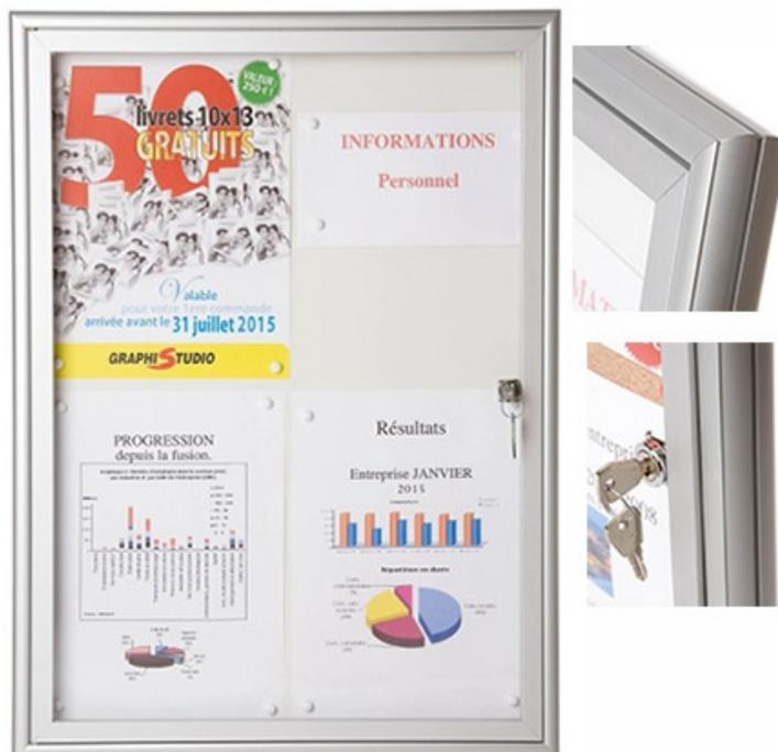
Vitrine d'intérieur avec cadre en aluminium anodisé. Fixation murale aux 4 coins de la tôle. Charnières sur pivot en laiton. Vitrage méthacrylate (version avec verre sécurit 4 mm, nous consulter). Serrure dans le vitrage. Fond tôle blanche laquée (modèle avec fond liège, nous consulter). Epaisseur hors tout 32 mm, utile 22 mm. Porte encastrée dans le fond de la vitrine. Porte battante. Modèle 9 A4. Dims (cm) hors tout : L68,4 x P3,2 x H94,5.
