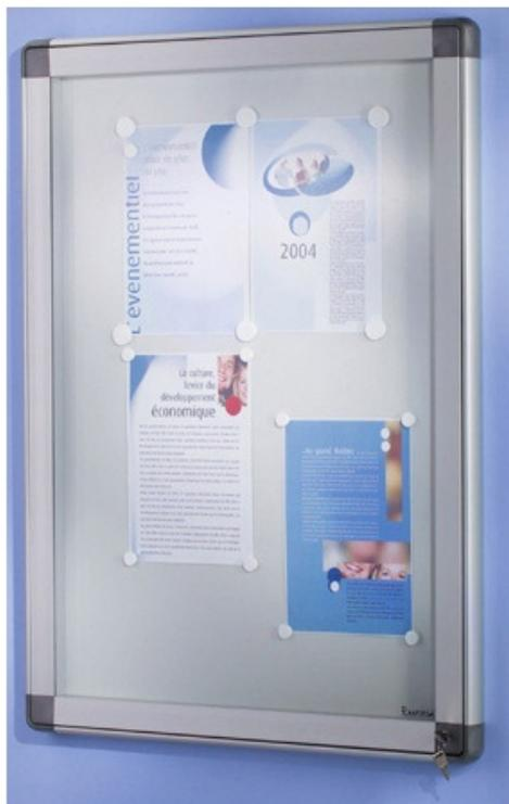
Profils aluminium anodisés 5 mm. Coins polycarbonate chargé à 10 en fibre de verre, aspect aluminium. Verre 4 mm posé siliconé. Serrure de sécurité pour intérieur intégrée dans le coin avec tringle de verrouillage (2 points d'ancrage). Epaisseur totale : 4,4 cm Epaisseur utile : 2,4 cm. Fixation par 4 vis et 4 chevilles (fournies).
