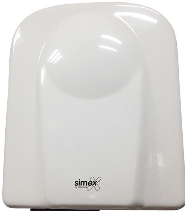
Sèche-mains hygiénique sans contact. Construction ABS blanc. Activation par un capteur infrarouge électronique et extinction automatique une fois les mains retirées du champ du capteur. Moteur universel à balais. Indicateur LED. Vitesse d'air : 57,6 km/h. Puissance totale de 1650 W. Tension 220-240V, 50/60 Hz. Niveau sonore : 65 dB. Indice de protection IPX1. Classe I. Fixation murale. Dims (cm) : L 17,7 X P 16 X H 28,2. Poids : 2,33 kg.
