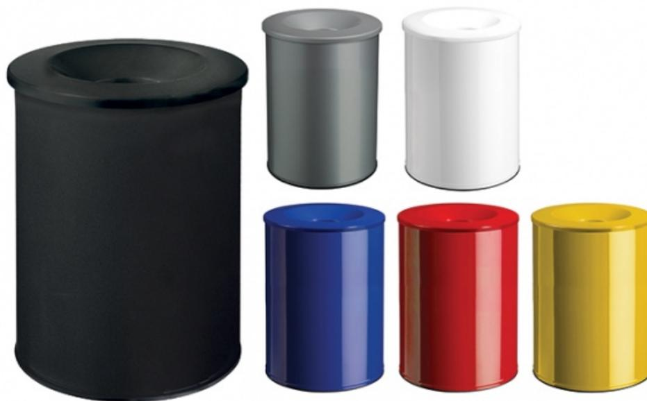
Corbeille anti-feu avec homologation du Centre National de Prévention et de Protection. Conformes aux normes de sécurité. Tête étouffoir en acier poudré époxy (ép. 1 mm). Elles empêchent la combustion des déchets et évitent la propagation du feu. Corps en acier poudré époxy (ép. 0,5 mm). 6 coloris au choix : bleu outremer 5002, rouge signalisation 3020, jaune colza 1021, gris clair 9022, blanc signalisation 9016, gris manganèse. Profilé caoutchouc antidérapant fixé sur la base de la corbeille.
