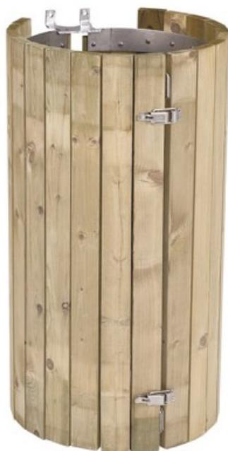
Entourage bois pour support de sac Nice. 2 ceintures inox AISI 304 maintiennent 22 lattes de bois résineux traité autoclave, épaisseur 20 mm. Fermeture par deux sauterelles en inox AISI 304. Dims (cm) : diamètre 47 X H 82. Poids 11,7 kg.
