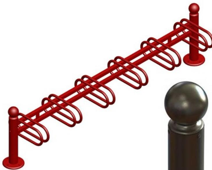
Support vélo 6 places, thermolaqué, coloris au choix nous consulter. Poteaux en tube acier de diamètre 76 mm. Traverse en tube acier 30x30. Arceaux en tube acier de diamètre 22 mm. Modèle à sceller. Dim (cm) : L 225.5 x H 56.2, hors sol 105. Poids 24.5 kg.
