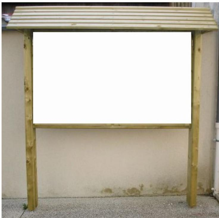
Version sans vitrine et avec toit. Structure bois essence pin nord rouge Finlande, catégorie 5, gage de stabilité et de haute résistance. Traitement autoclave classe IV, sans chrome ni arsenic. Visserie inox A2. Panneau en compact ép. 10 mm ou PVC komacel ép. 10 mm. Livré pré monté, à sceller. Option toit : clin plat à 2 pentes. Option vitrine : plexiglass 6 m, verrou avec serrure. Hauteur 220 cm.
