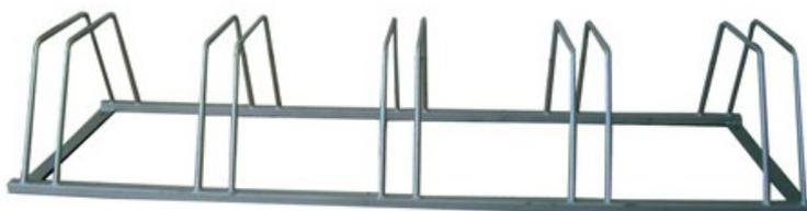
Range vélos 5 places double accès. Réalisé en tube d'acier carré 25 X 25 X 2 mm et en rondin de 12 mm. Finition galvanisée. Fixation au sol par chevillage chimique. Dims (cm) : L 168 X P 52 X H 32.
