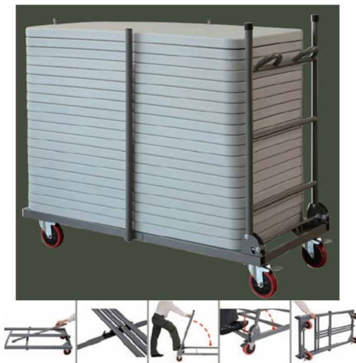
Chariot pliable fabriqué en acier peint par pulvérisation, coloris gris. Poteaux verticaux amovible pour une meilleure immobilisation des tables. 2 anses pour protéger les mains et pousser facilement le chariot. Ce chariot se plie entièrement à plat pour un rangement optimum. 4 roues en polyuréthane avec frein. Quantité maximum de tables : 20. Dims (cm) : L131,83 X P61,98 X H115,06. Poids 21,3 kg.
