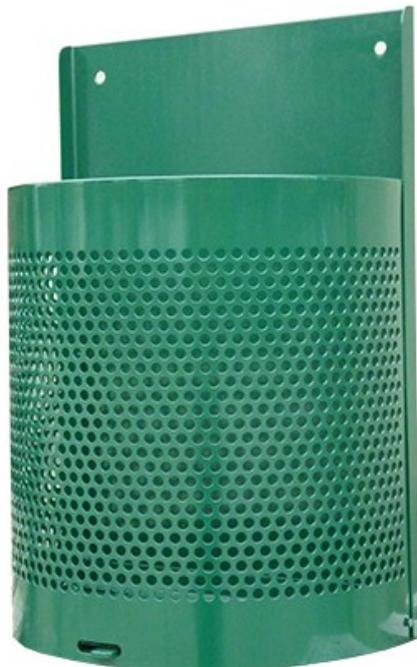
Corbeille murale avec fond ouvrant à clef. Fabriquée en tôle épaisseur 15/10 ème. A fixer au mur ou sur poteau disponible en option ref 148103 (poteau en tube métal diam. 32 mm). Peinture cuite au four RAL vert 6005. Dims (cm) de la corbeille : H réceptacle 36 / H totale 50 / P 20 / L 34. Poids 5kg.
