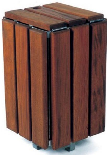
Réalisée avec des lattes de bois exotique très résistant. Finition peinture microporeuse acrylique spéciale bois marron RAL 8011, donnant un aspect satiné en même temps qu'une protection anti-UV. Equipée d'un bac en tôle galvanisée amovible, qui peut également être rendu fixe. L'ossature est en acier galvanisé. Elle possède des pattes de scellement pour fixation au sol. Avec couvercle. Dims. (cm) : l x L X H : 43 X 43 X 73.
