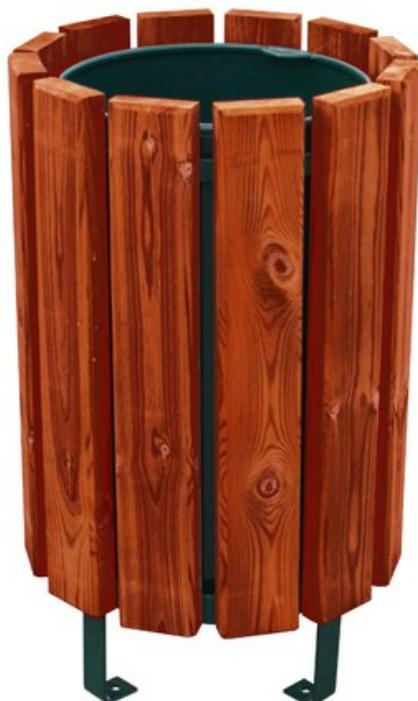
Corbeille fabriquée avec une structure acier, finition peinture au four coloris vert RAL 6005. Habillage par 12 lames de bois traité et vernis en pin du nord. Equipée d'un seau amovible. Socle de fond. Volume 80 L. Dims (cm) : diamètre 45 X H 83. Poids : 30 kg. A poser ou à sceller.
