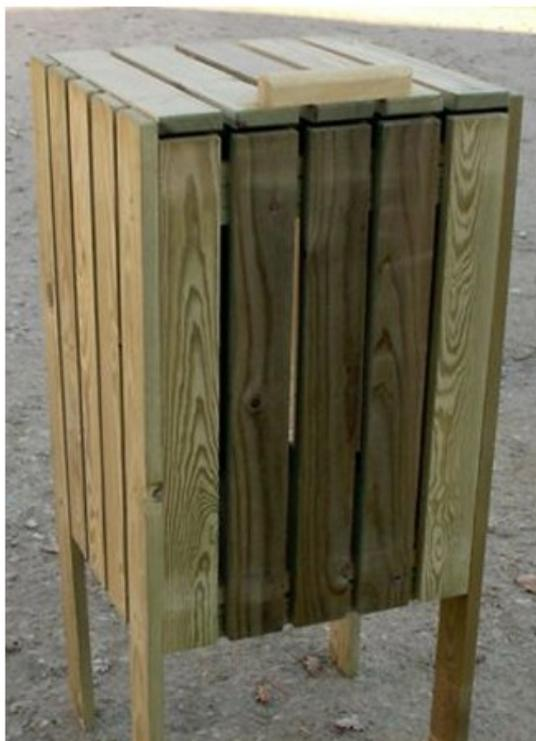
Corbeilles à face avant escamotable. Couvercle maintenu par chaînette et charnière. Maintien du sac par un cadre en bois. Structure en pin du nord rouge Finlande, catégorie 5, gage de stabilité et de haute résistance. Bois traité autoclave classe IV, sans chrome ni arsenic. Visserie inox A2. Lames de section 68 X 22 mm. Livrées montés, à sceller. Volume 160 L. Dims (cm) : L 53 X P 48 X H 75.
