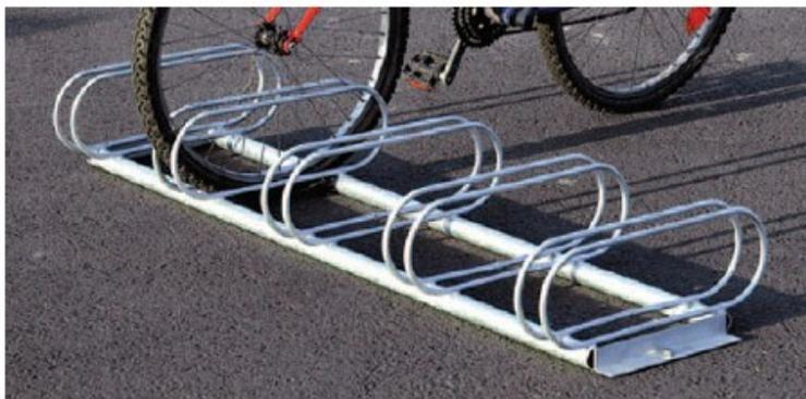
Support vélos très pratique et économique, ils s'utilisent des 2 côtés. Fabriqué en acier galvanisé. 2 tubes section 38 X 1,5 mm servent de base. Arceaux en tube de section 12 X 1,2 mm. Dims (cm) des arceaux : H 51,5 X P 18 X L 5. Ecartement entre 2 arceaux : 28 cm. Fixation au sol par plaques latérales.
