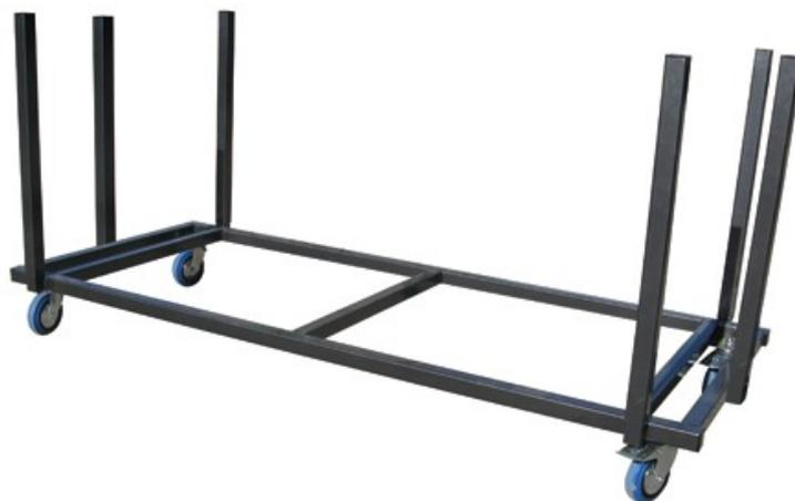
Pour les tables 183 X 76 cm (20 tables par chariot). Structure robuste en tube d'acier section 40 X 40 mm. 4 roues à bandage caoutchouc diamètre 125 mm, 2 fixes et 2 pivotantes avec frein. Chariot équipé de barres de guidage et de 4 tubes latéraux amovibles.
