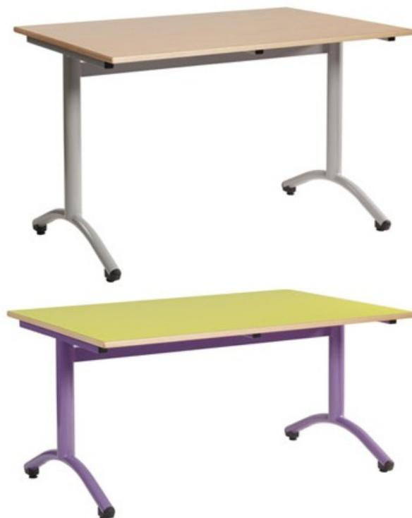
Tables livrées montées. Tailles de 1 à 6. Garantie 10 ans. Table à dégagement latéral : piétement monobloc, montants diamètre 60 mm et embases diamètre 40 mm. Structure sous plateau en tube 30 x 30 mm et traverse 50 x 20 mm. Vérins et embouts de réglage en polyéthylène noir non tachant. Plateau stratifié épaisseur 22 mm. Chants surmoulés : Résine polyuréthane noire injectée à chaud dans un moule pour recouvrir le bord du plateau. Plusieurs coloris de plateaux et de piétement au choix.
