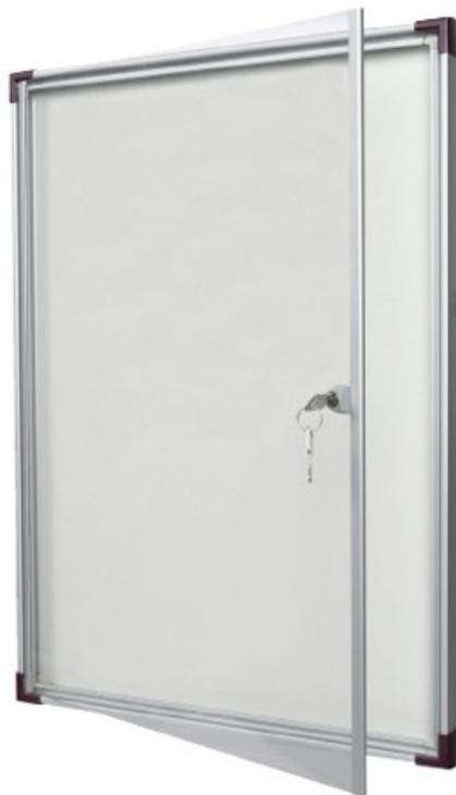
Vitrine extra plate ép. totale 3 cm à porte battante. Encadrement aluminium anodisé avec 4 coins plastique. Porte en plexiglas ép. 3 mm avec bordures verticales en aluminium. Serrure de sécurité (livrée avec 2 clefs). Fond en tôle laquée blanche pour affichage magnétique et écriture au feutre (épaisseur utile 2 cm). Fixation murale invisible. Dims en cm: H 45,1 X L 62,5.
