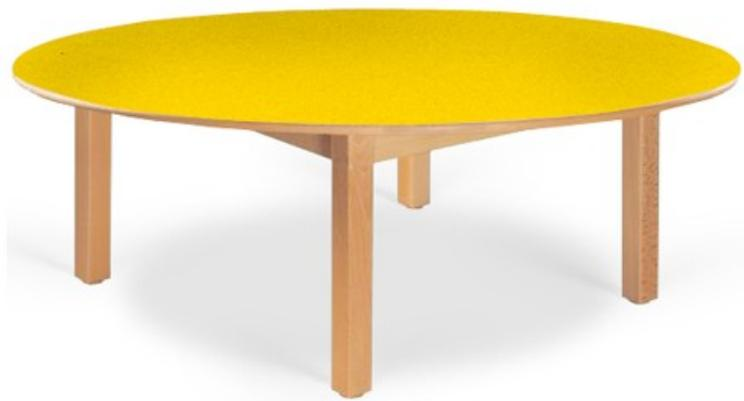
Tailles 0,1,2 ou 3. Table structure 4 pieds 50 x 50 mm en hêtre massif, cadre porteur 80 x 20 mm. Piétement hêtre massif, patins PVC anti tâches, insonores. Vernis naturel ou teinté polyuréthane bicouche. Plateau stratifié 20 mm alaisé bois. 12 coloris au choix. Fabrication UE conforme aux normes NF EN 1729-1 et 1729-2. Normes environnementales : Bois PEFC. Garantie 7 ans contre tous vices de fabrication.
