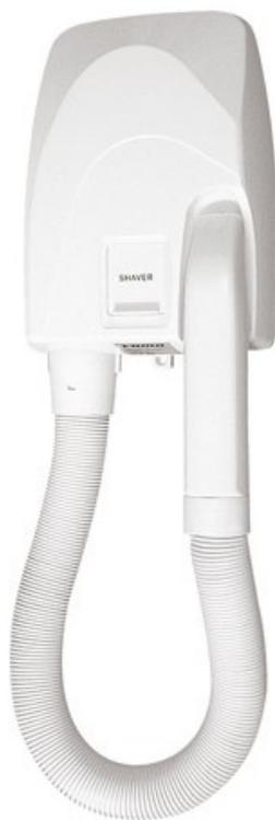
Sèche-cheveux mural en ABS avec tube flexible. Equipé d'une prise rasoir 110/220 V. 2 vitesses, 600 et 1000 W. Débit d'air max 30 L / s. Arrêt automatique au bout de 10 minutes en cas de non repositionnement du tube. Thermostat de sécurité. Classe II. Tension 220 / 240 V. Fréquence 50-60 Hz. Garantie 3 ans. Dims (cm) : L 18,4 X P 11,7 X H 59. Poids : 0,9 kg.
