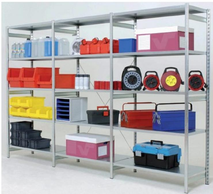
Un rayonnage en acier galvanisé tôle avec des échelles ouvertes. Montants sans perforations en façade. Il s'assemble très facilement avec des traverses en tôle. Charge jusqu'à 200 kg par tablette, selon les configurations. Montage facile et rapide sans vis ni boulon.
