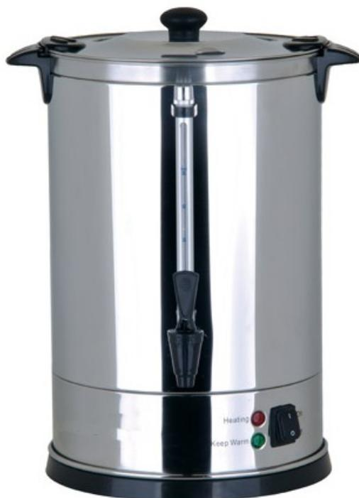
Percolateur performants et économiques. Filtre inox permanent. Boîtier inox à double paroi anti-brûlure. 2 systèmes de chauffe séparés pour la percolation et le maintien de température. Thermostat de sécurité à réarmement automatique. Robinet anti-gouttes. Indicateur de remplissage. Capacité 6,8 L = 48 tasses. Temps de préparation 50 min. Puissance 950 W. Tension 230 V. Dims (cm) : diamètre 21 X H 37. Poids : 4,6 kg.
