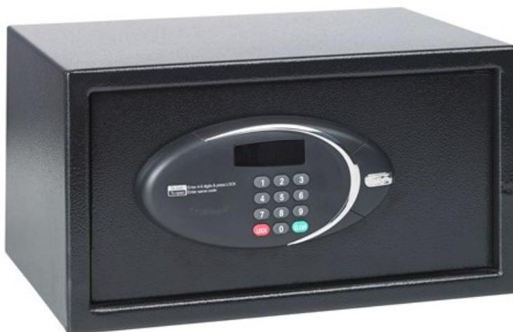
Coffre fort pour hôtel compact et moderne. Verrouillage par code à 4 à 6 chiffres. Blocage pendant 15 minutes après 4 essais erronés. Alimentation par 4 piles 1,5 V type LR6 (AA) fournies. Alerte en cas de piles faibles. Fermeture par 2 pennes acier diamètre 20 mm. Corps en acier ép. 2 millimètres. Porte en acier ép. 4 millimètres. Fixation par 2 points au dos et à la base du coffre. Eclairage intérieur : Oui
